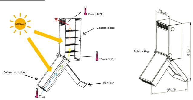
CLIPSOL, fort de ses 35 ans d'expérience dans le solaire, a mis au point un système de séchage optimal en mixant 2 technologies : le séchage solaire indirect, grâce au caisson absorbeur, et le séchage solaire direct grâce à la vitre du caisson claies.
